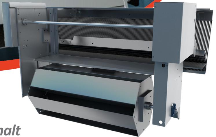
Der Autark-Siebrechen der Marke GiWA wird vom integrierten Wasserrad angetrieben und kann mittels Mobilfunk vollständig an Prozessleitsysteme angebunden und in Echtzeit überwacht werden. Durch die intelligente Nutzung der natürlich vorhandenen Hydroenergie erfordert der gesamte Prozess dabei keine Strom-Netzversorgung. Der um-
