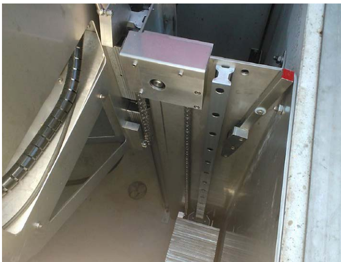
Mécanisme de levage avec contrepoids (en bas) et levier de blocage (à droite).
