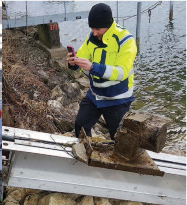
Réception des convertisseurs remontés. Les dépôts ne gênent pas le signal acoustique.
