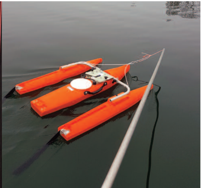
Plusieurs mesures ADCP ont permis de calibrer le point de mesure en effectuant des mesures comparatives à différents écoulements.
