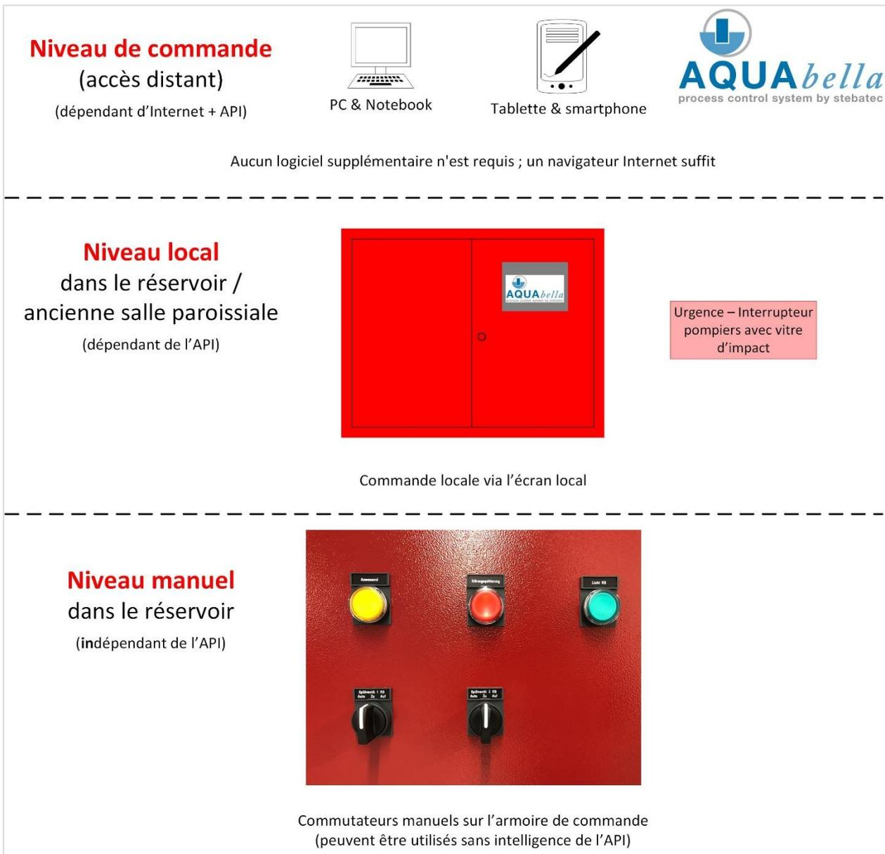
Figure 2: Concept d'exploitation à 3 niveaux
