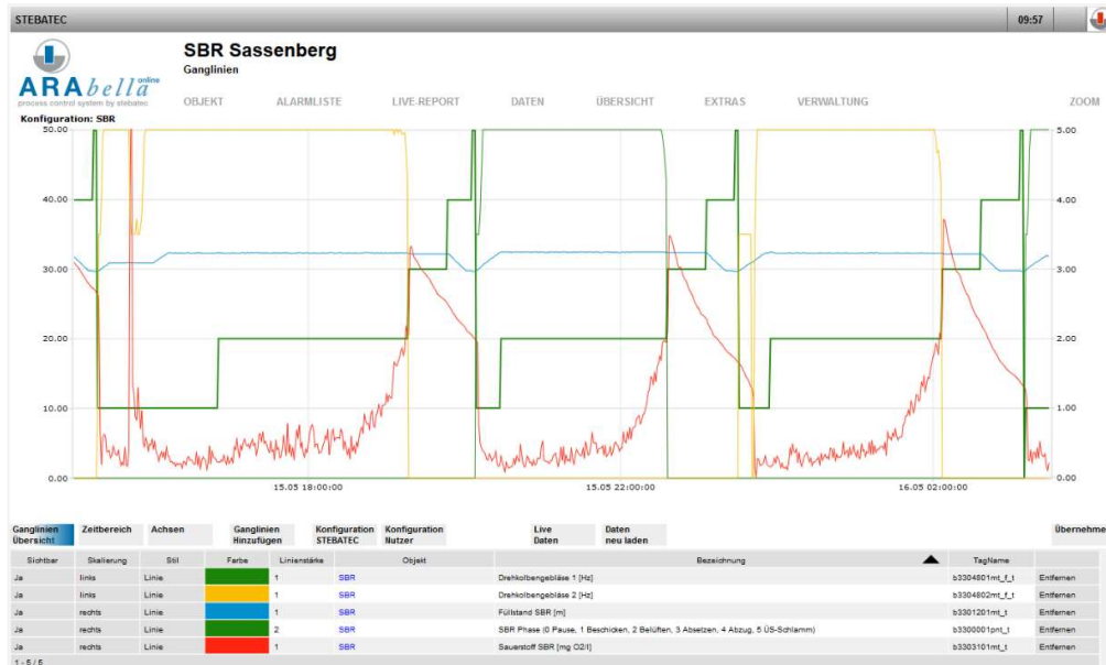
Figure 4. Les graphiques représentent 3 cycles. La durée des cycles n'est pas la même pour chaque cycle. La phase d'aération est terminée lorsque la concentration en oxygène dépasse 1,8 mg/l.
