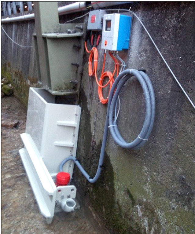
Point de mesure 3 à l'embouchure Nord du tunnel, Mesure de débit stationnaire Section nominale 100
