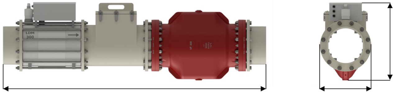
Abbildung 21: Mass Bild LDM-gesteuerte pneumatische Abflussregelung mit Quetschventil
